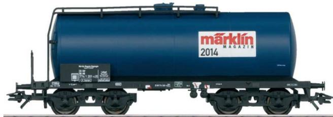
Einheitsleichtkesselwagen Bauart Uerdingen,
