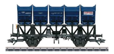
**Vorbild:** Zweiachsiger Muldenkippwagen Bauart F-z 120 (ex Ommi 51). Privatwagen des Märklin Magazins, Göppingen, eingestellt bei der Deutschen Bundesbahn (DB). Mit Handbremse und Bremserstand, mit Schienenzangen. Betriebszustand um 1990.
