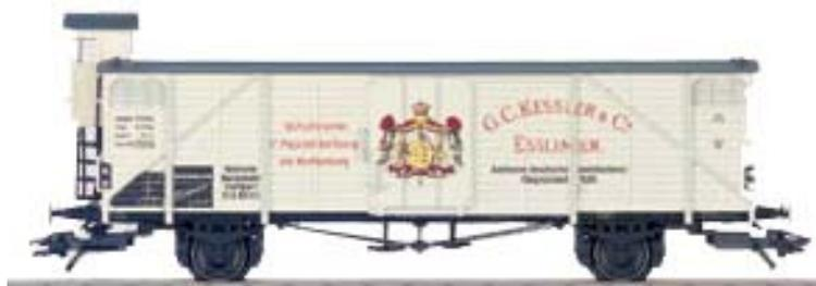
Gedeckter Güterwagen mit Bremserhaus GI der DRG.
