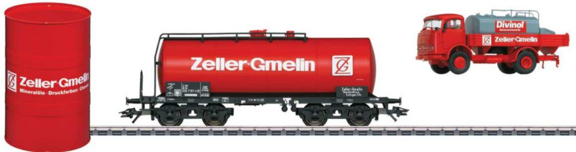
**Vorbild:** Vierachsiger Einheitskesselwagen, ältere Bauart mit Pressblech-Drehgestellen und Bremserbühne. Privatwagen der Firma Zeller + Gmelin GmbH & Co.KG, Mineralölraffinerie, Eislingen/Fils, eingestellt bei der Deutschen Bundesbahn (DB). LKW-Tankfahrzeug MB LP 328 als flacher Frontlenker der Firma Zeller + Gmelin zum Transport von Raffinerie-Produkten. Betriebszustand Mitte/Ende der 1970er Jahre.
