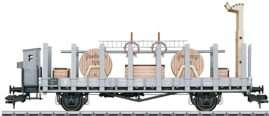
**Vorbild:** Rungenwagen der Verbandsbauart (R10) mit Handbremse und Bremserhaus, ausgerüstet zum Oberleitungsbau (sog. Trommelwagen) der Firma Sommerfeldt, Hattenhofen bei Göppingen, eingestellt bei der DB. Betriebsnummer 512 523 P.
