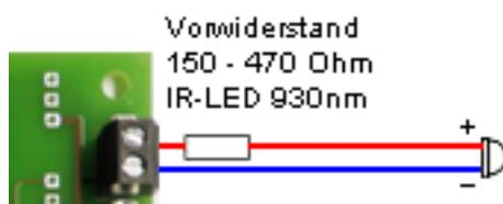
Der Widerstandswert bestimmt den Abstand, in dem ein Auto den abgestrahlten Befehl erkennt. Je niedriger der Wert ist, desto größer ist die Entfernung. Bei 330 Ohm sind dies ungefähr 10cm.
