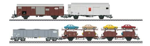
Vorbild: 5 Güterwagen unterschiedlicher Bauarten. Davon 3 Wagen der Schweizerischen Bundesbahnen (SBB) und ein Autotransportwagen-Paar der Deutschen Bundesbahn (DB). 1 Hochbordwagen Eaos, 1 gedeckter Güterwagen Gbs, 1 gedeckter Güterwagen Hbck und 1 Autotransportwagen-Paar Laaes 541. Alle Wagen im Betriebszustand Ende der 1970er Jahre.
