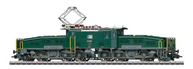
Vorbild: Güterzuglokomotive Serie Ce 6/8 II "Krokodil" der Schweizerischen Bundesbahnen (SBB). Bauart aus der ersten Bauserie in der Ausführung als Rangier-Krokodil mit 1 Stromabnehmer, Rangiererbühne, Rangierertreppen, Hülsenpuffer, Ölkühlerkasten. Tannengrüne Grundfarbgebung. Lok-Betriebsnummer 14282. Betriebszustand Ende der 1970er Jahre.
